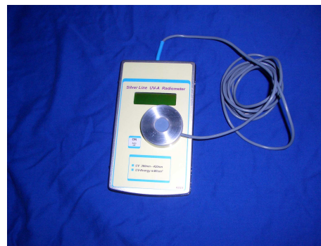
LED-UV-Messgerät Silverline für den Wellenlängenbereich 380-420 nm
